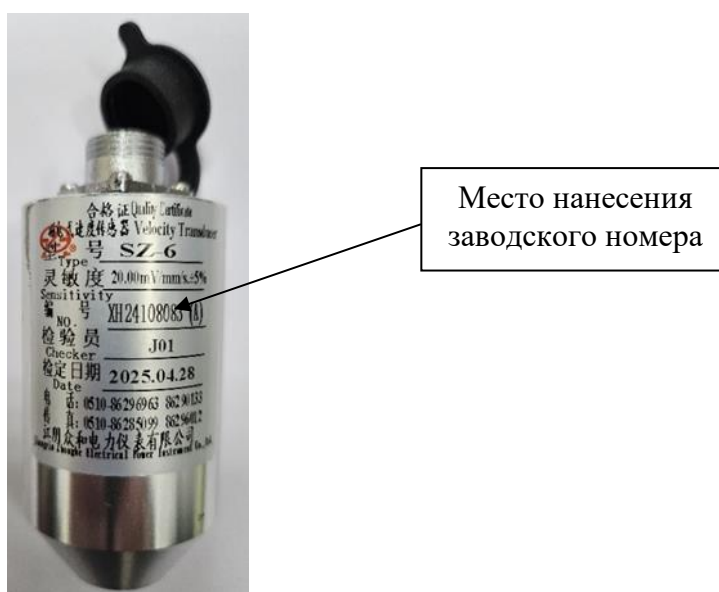
Рисунок 1 – Общий вид датчиков виброскорости SZ-6
