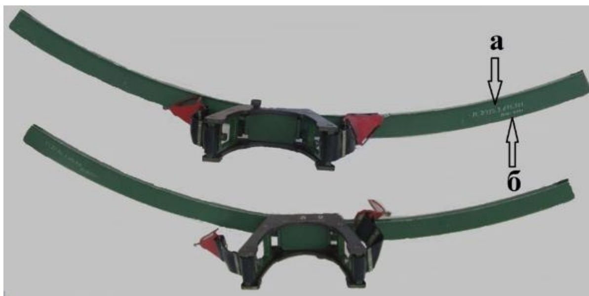
а – место нанесения маркировки, б – место нанесения заводского номера
