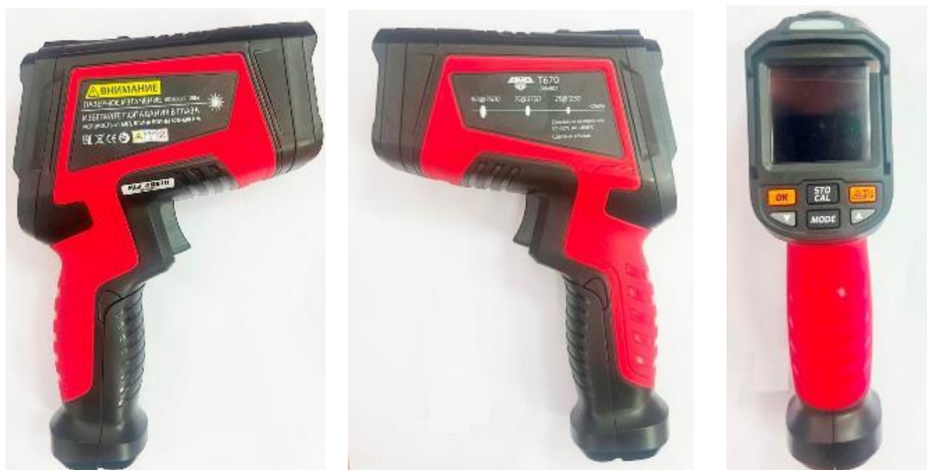
Рисунок 4 – Общий вид пирометров моделей АМО Т670, АМО Т671, АМО Т672, АМО Т673, АМО Т674
