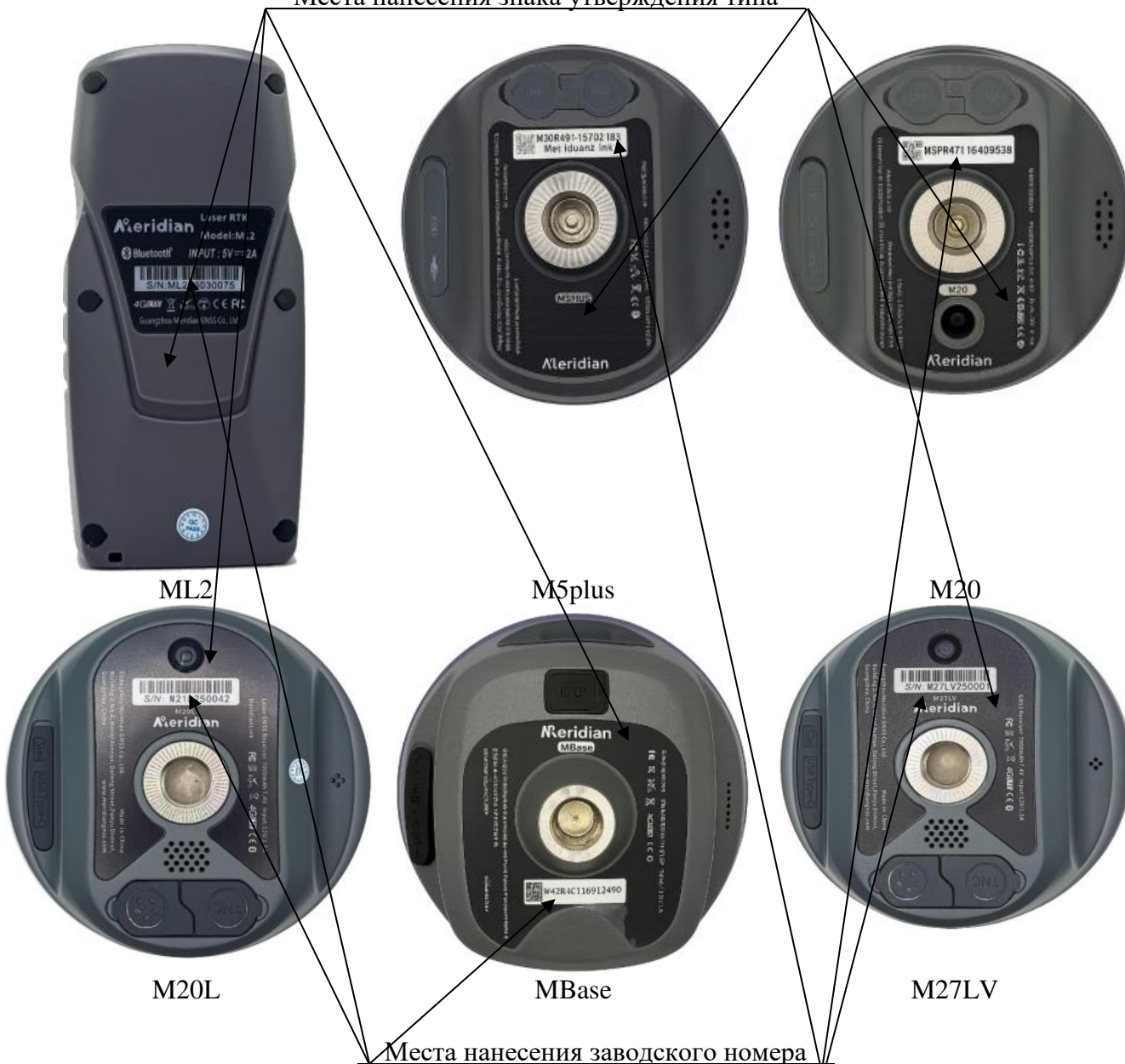
Рисунок 2 – Вид аппаратуры со стороны нижней панели корпуса с указанием мест нанесения знака утверждения типа и заводского номера
