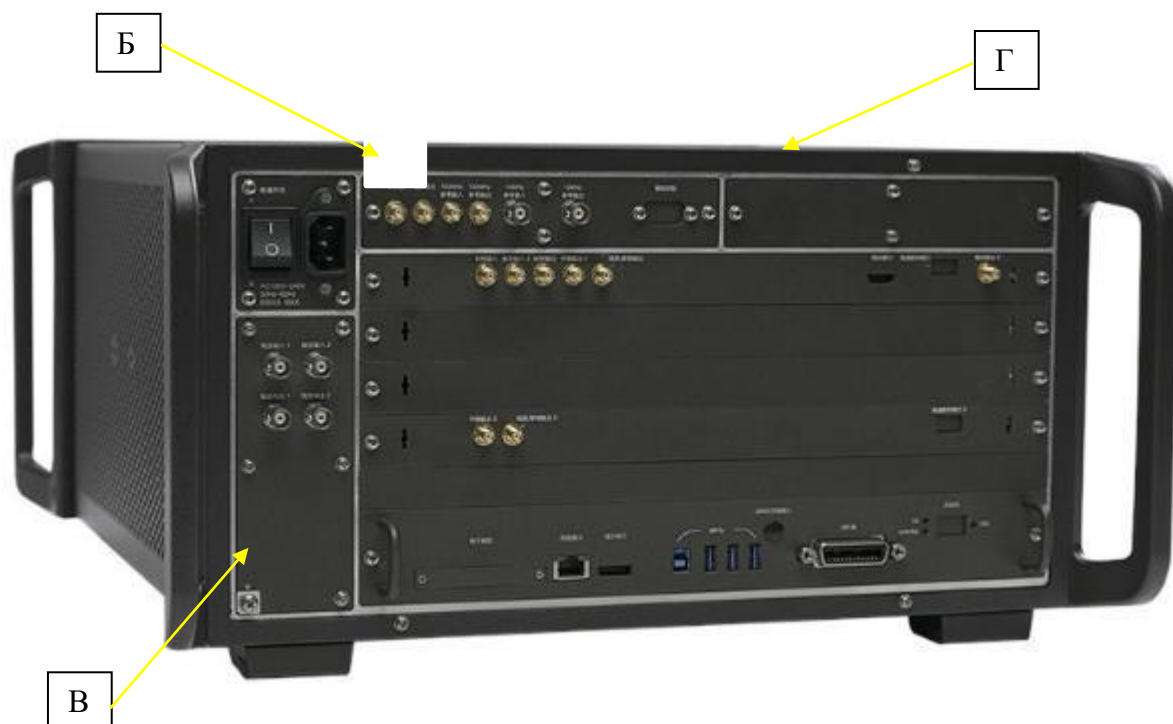
Рисунок 2 – Схема пломбировки от несанкционированного доступа (Б), место нанесения серийного номера (В) и знака поверки (Г).
