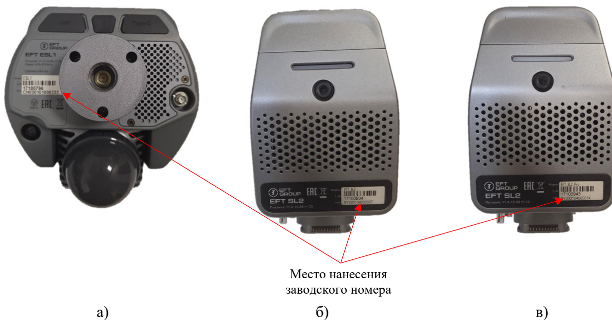
Рисунок 2 – Место нанесения заводского номера: а) модификация ESL1; б) модификация SL2; в) модификация SL2 Pro
