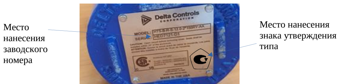
Рисунок 2 – Пример шильда с заводским номером
