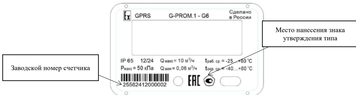
Рисунок 2 – Места расположения заводского номера и нанесения знака утверждения типа
