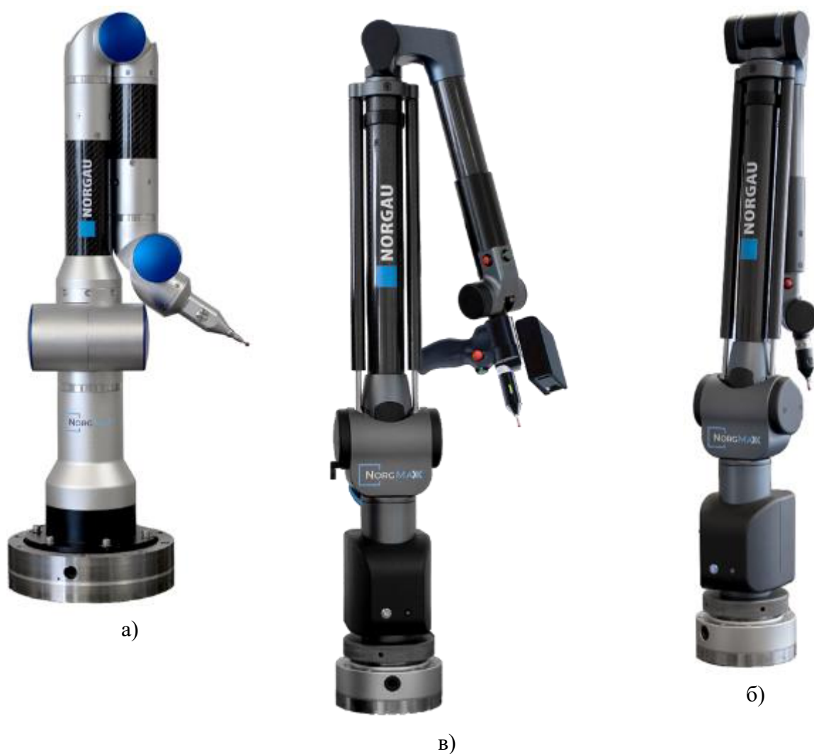
Рисунок 1 – Общий вид машины координатно-измерительной портативной NORGGAU NCMA: а) NorgBase; б) NorgMaxx; в) NorgMaxx со сканером
