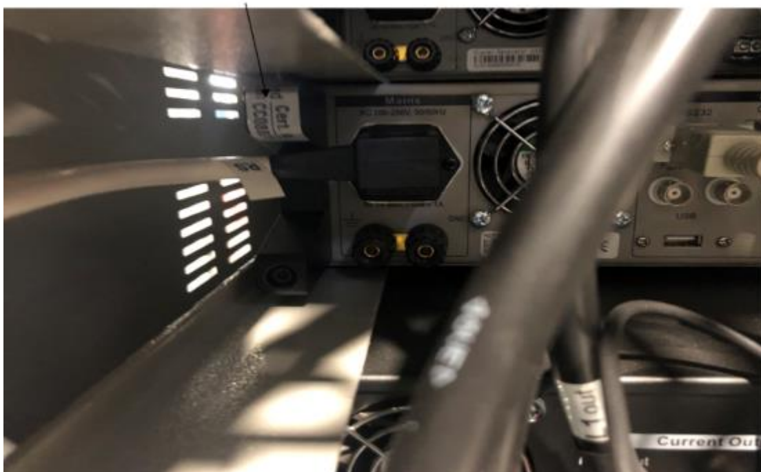
Рисунок 2 – Схема пломбировки от несанкционированного доступа
