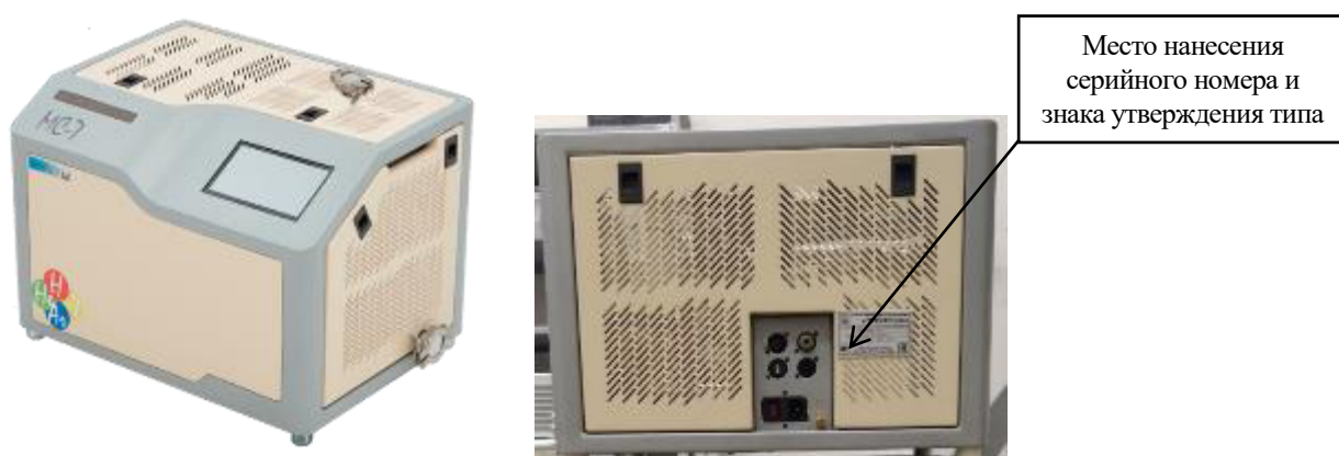
Рисунок 2 – Общий вид течеискателей масс-спектрометрических гелиевых МС, исполнение МС-7, место нанесения серийного номера и знака утверждения типа
