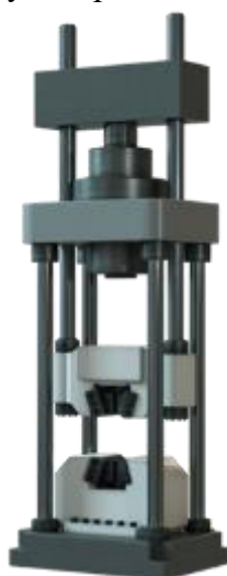
Рисунок 3 – Общий вид машины вертикальной, четырехколонной, с двумя рабочими зонами, с верхним расположением гидроцилиндра испытательной универсальной РГМ-XXXX-B-C-D
