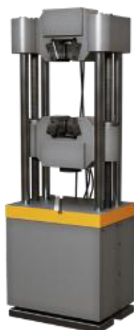
Рисунок 2 – Общий вид машины вертикальной, четырехколонной, с двумя рабочими зонами испытательной универсальной РГМ-XXXX-B-C-D
