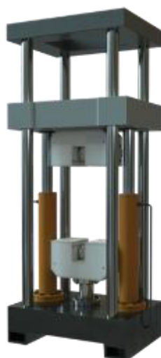
Рисунок 6 – Общий вид машины вертикальной, четырехколонной, с одной рабочей зоной испытательной универсальной РГМ.І-XXXX-В-С-Д
