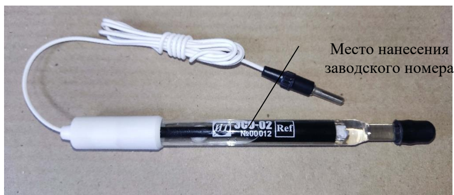
Рисунок 1 – Внешний вид электрода сравнения хлорсеребряного насыщенного образцового 2-го разряда ЭСО-02
