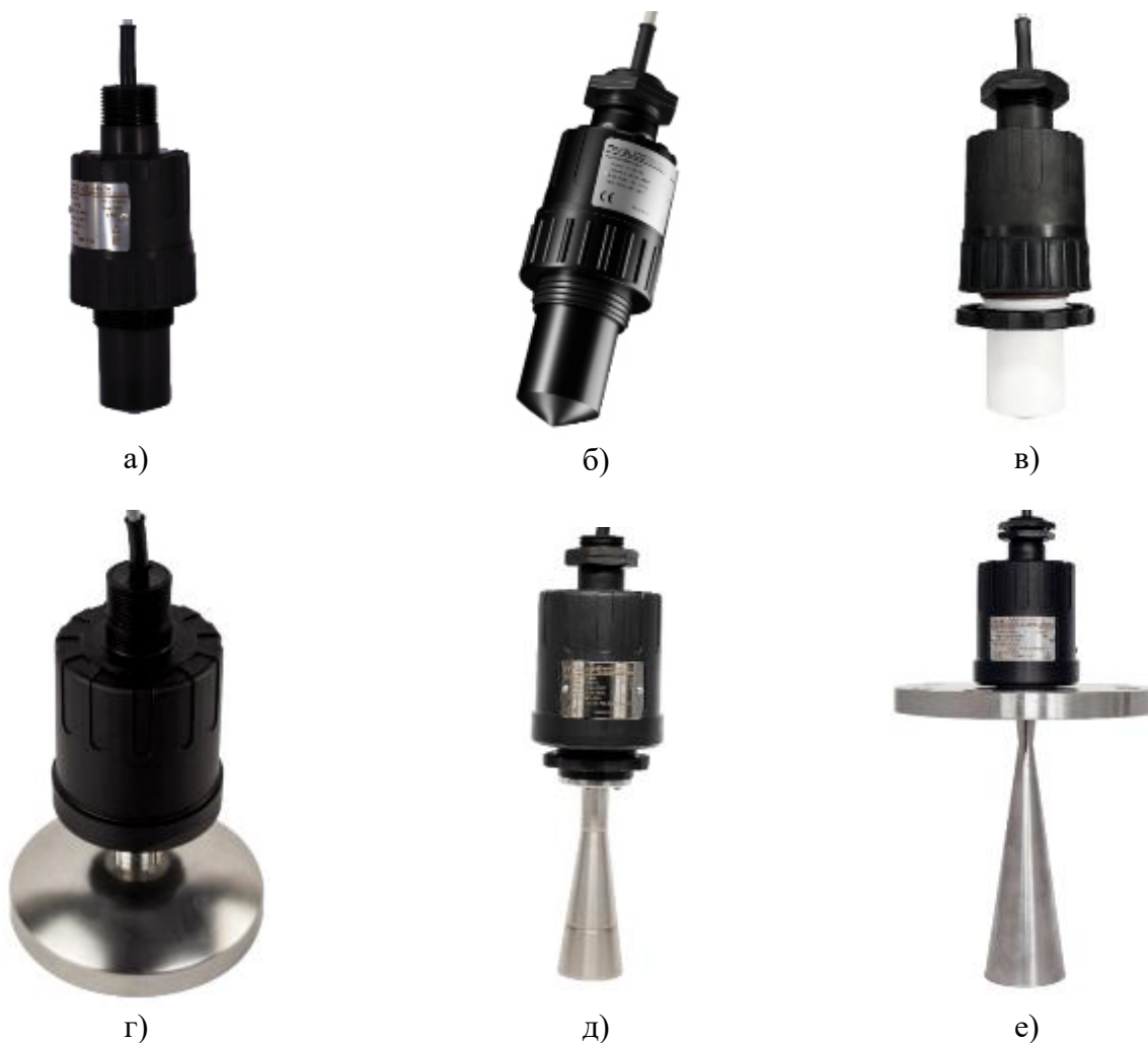
Рисунок 2 – Общий вид уровнемеров модификация PilotREK WP: а) тип присоединения «1" BSP / 1" BSP»; б) тип присоединения «1½" BSP / 1" BSP»; в) тип присоединения «1½" BSP / 1" BSP», материал антенны PVDF; г) с параболической антенной; д) с рупорной антенной; е) с рупорной антенной и фланцевым соединением
