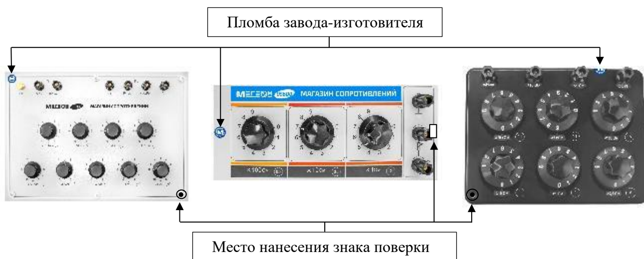
Р и с у н о к 3 – Схема пломбировки от несанкционированного доступа и место нанесения знака поверки
