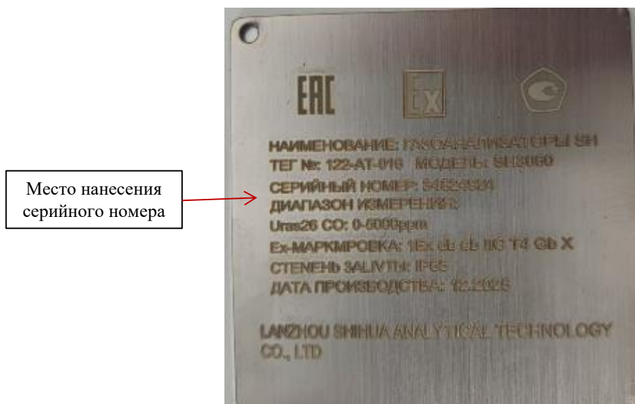
Рисунок 7 – Идентификационная табличка (шилдь)
