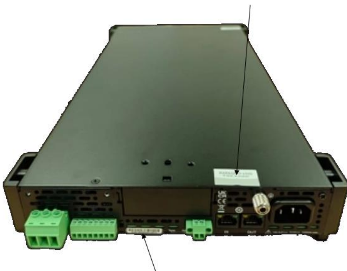
Рисунок 2 – Место нанесения заводского номера и место пломбирования от несанкционированного доступа источников питания постоянного тока двунаправленных IT-M3400
