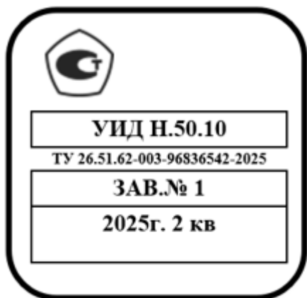
Рисунок 3 – Общий вид маркировочной таблички с указанием места нанесения знака утверждения типа и заводского номера
