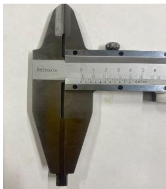
Рисунок 8 – Общий вид штангенциркулей с твердосплавными губками
