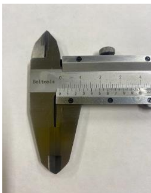
Рисунок 8 – Общий вид штангенциркулей с твердосплавными губками
