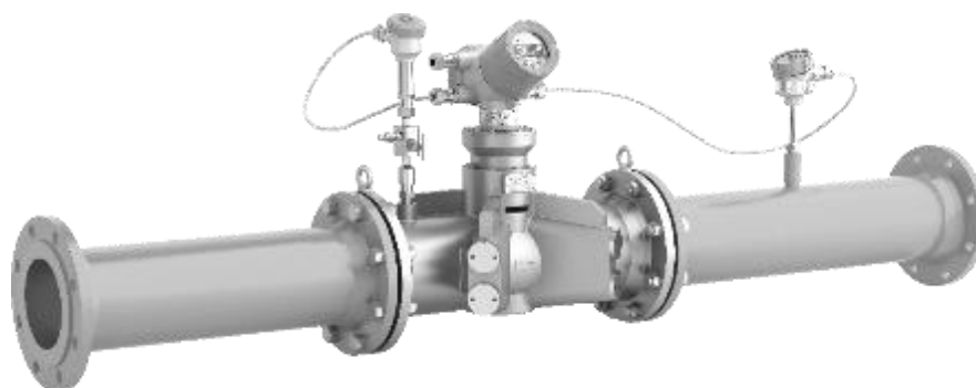
Рисунок 4 – Общий вид расходомера-счетчика ЭЛЕМЕР-РУЗ-03, оснащенного термопреобразователем сопротивления, установленным в трубопровод на постушке и преобразователем давления измерительным, установленным в корпус первичного преобразователя расхода
