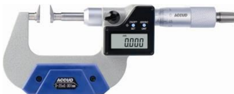
Рисунок 23 – Общий вид микрометров модификации 342: а) с невращающимся шпинделем (исполнения 342-ААА-01); б) с вращающимся шпинделем (исполнения 342-ААА-02)
