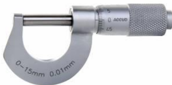
Рисунок 4 – Общий вид микрометров модификации 320
