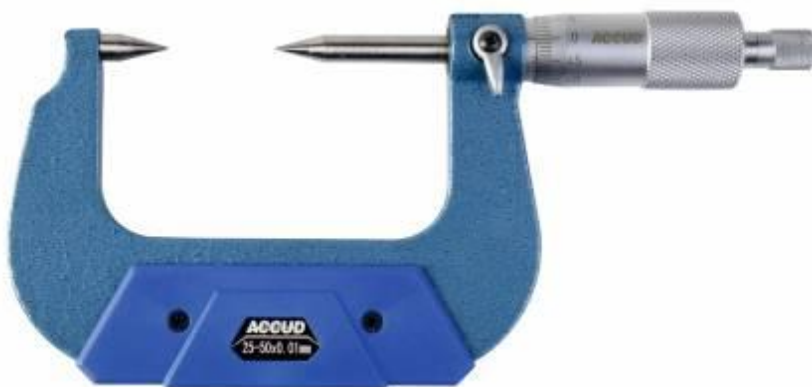
Рисунок 32 – Общий вид микрометров модификации 327
