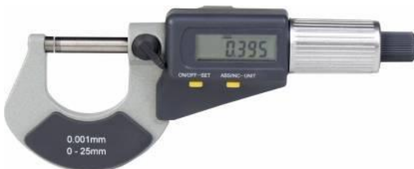
Рисунок 9 – Общий вид микрометров модификации 312
