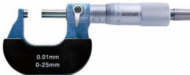
Рисунок 7 – Общий вид микрометров модификации 323
