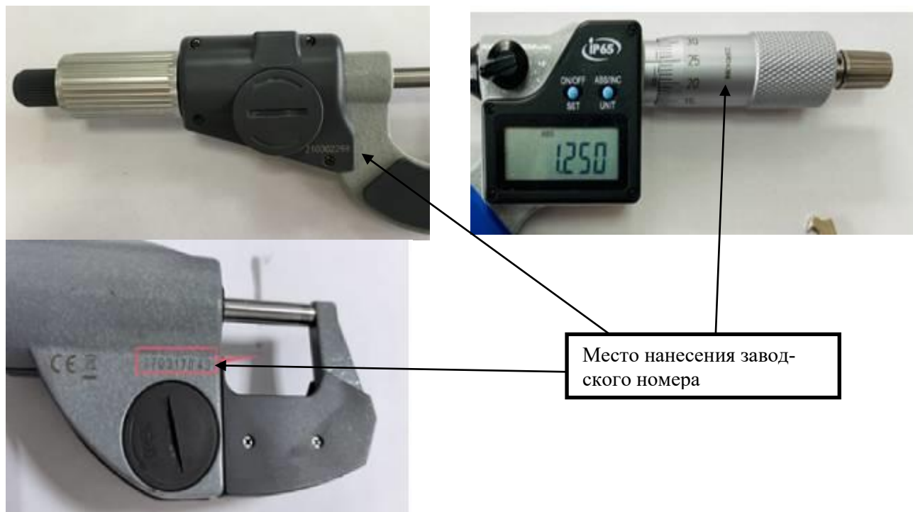
Рисунок 1 – Возможные места нанесения заводского номера
