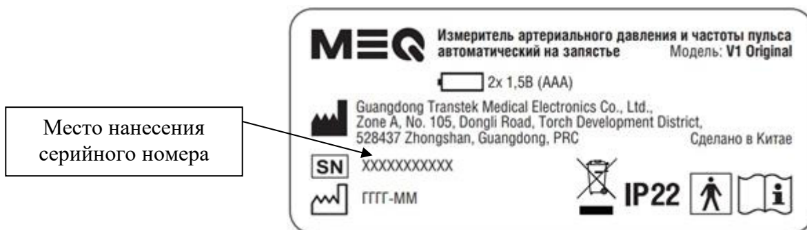
Рисунок 2 – Схема маркировки и место нанесения серийного номера измерителей модификации: V1 Original, V2 Comfort
