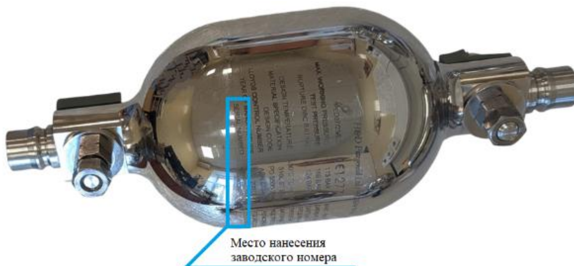
Рисунок 1 – Общий вид пикнометра с указанием места нанесения заводского номера
