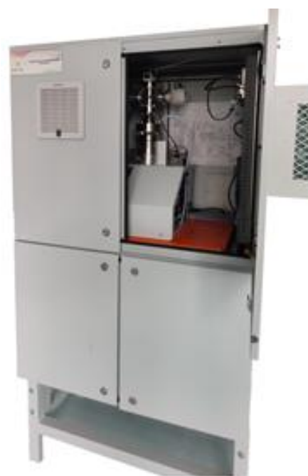
б) шкаф газоаналитический (квадрупольный масс-анализатор)
