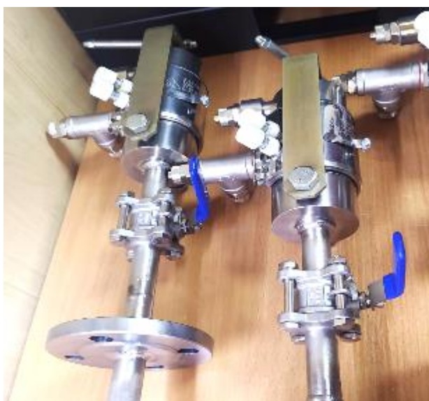
д) пробоотборное устройство с внешней фильтрацией и дополнительном обогревом фильтра
