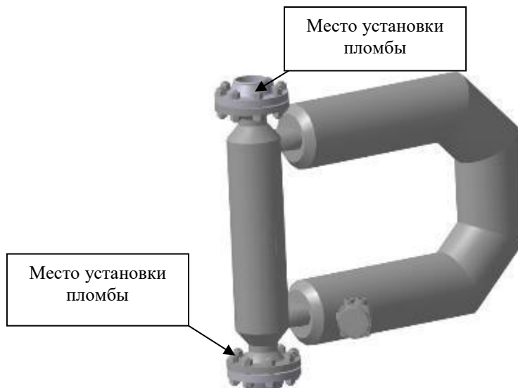
Рисунок 1 – Места установки пломб для защиты от несанкционированных настройки и вмешательства модели сенсора СМФ
