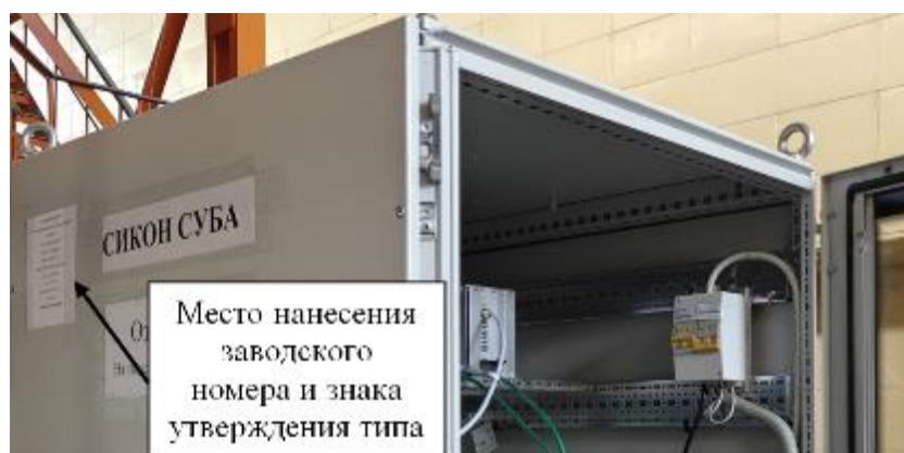
Рисунок 3 – Место нанесения заводского номера и знака утверждения типа
