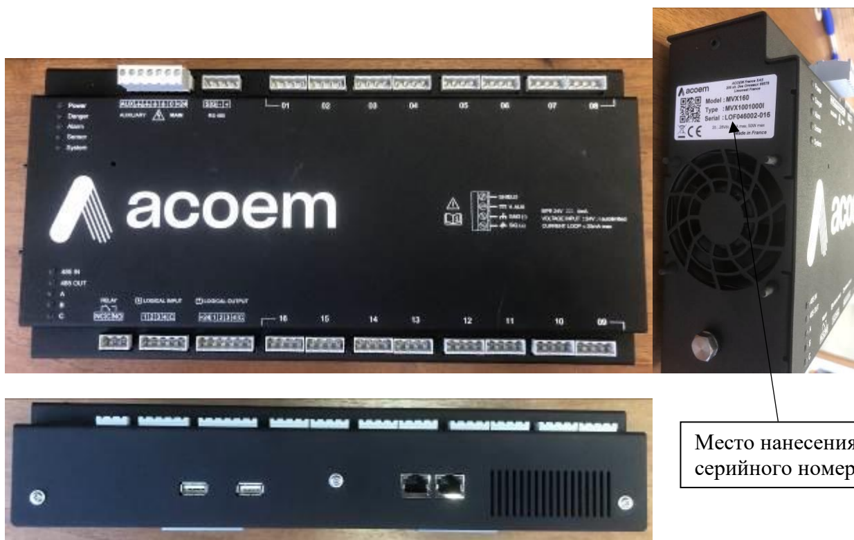
Рисунок 2 – Общий вид комплексов измерительно-вычислительных для мониторинга работающих механизмов АСОЕМ модификаций MVX060, MVX080, MVX120, MVX160, MVX240 и MVX320
