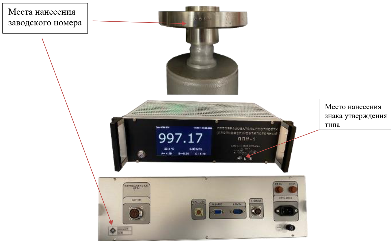
Рисунок 2 – Места нанесения заводского номера и знака утверждения типа преобразователей плотности (плотномеров) нефти поточных ППН-1
