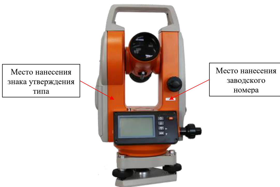
Рисунок 2 – Места нанесения знака утверждения типа и заводского номера
