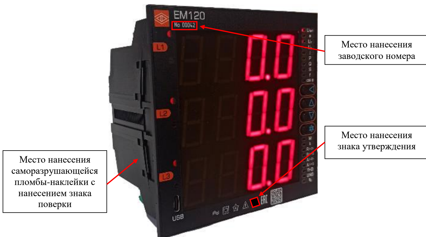
а) вид спереди измерителей исполнения EM120 с указанием места ограничения доступа к местам настройки (регулировки), места нанесения знака утверждения типа, места нанесения заводского номера
