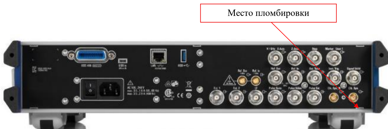
Рисунок 2 – Вид задней панели генераторов с указанием мест пломбировки
