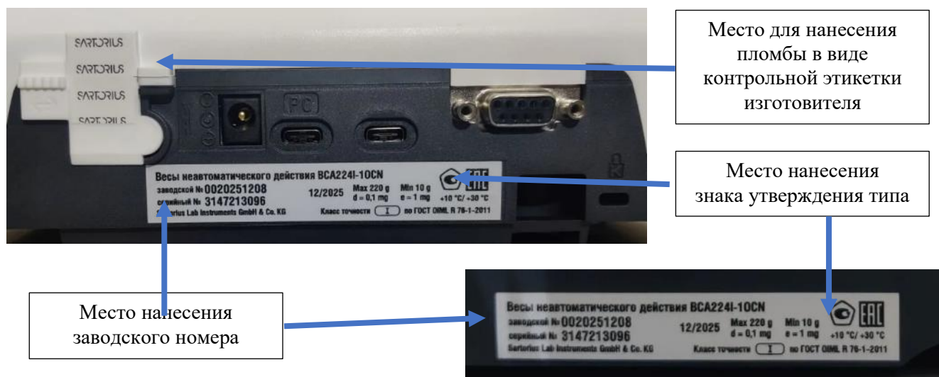
Рисунок 3 – Место пломбирования весов от несанкционированного доступа; место нанесения знака утверждения типа; место нанесения заводского номера
