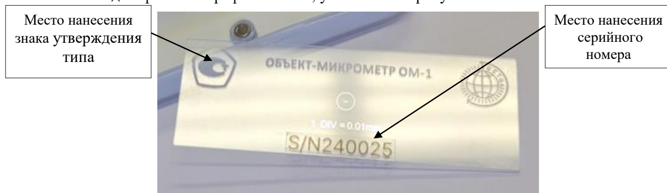
Рисунок 1 – Общий вид объект-микрометра ОМ-1 с указанием мест нанесения знака утверждения типа и серийного номера
