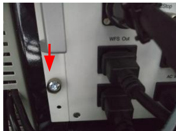
Рисунок 3 – Место пломбирования дифрактометров рентгеновских ДРОН на задней панели БУСД
