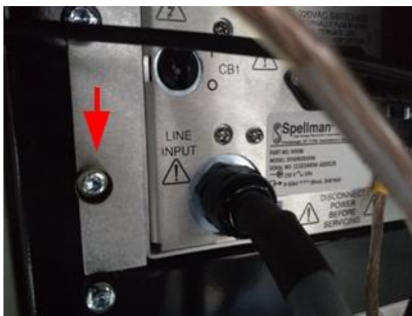
Рисунок 2 – Место пломбирования дифрактометров рентгеновских ДРОН на задней панели ВИП
