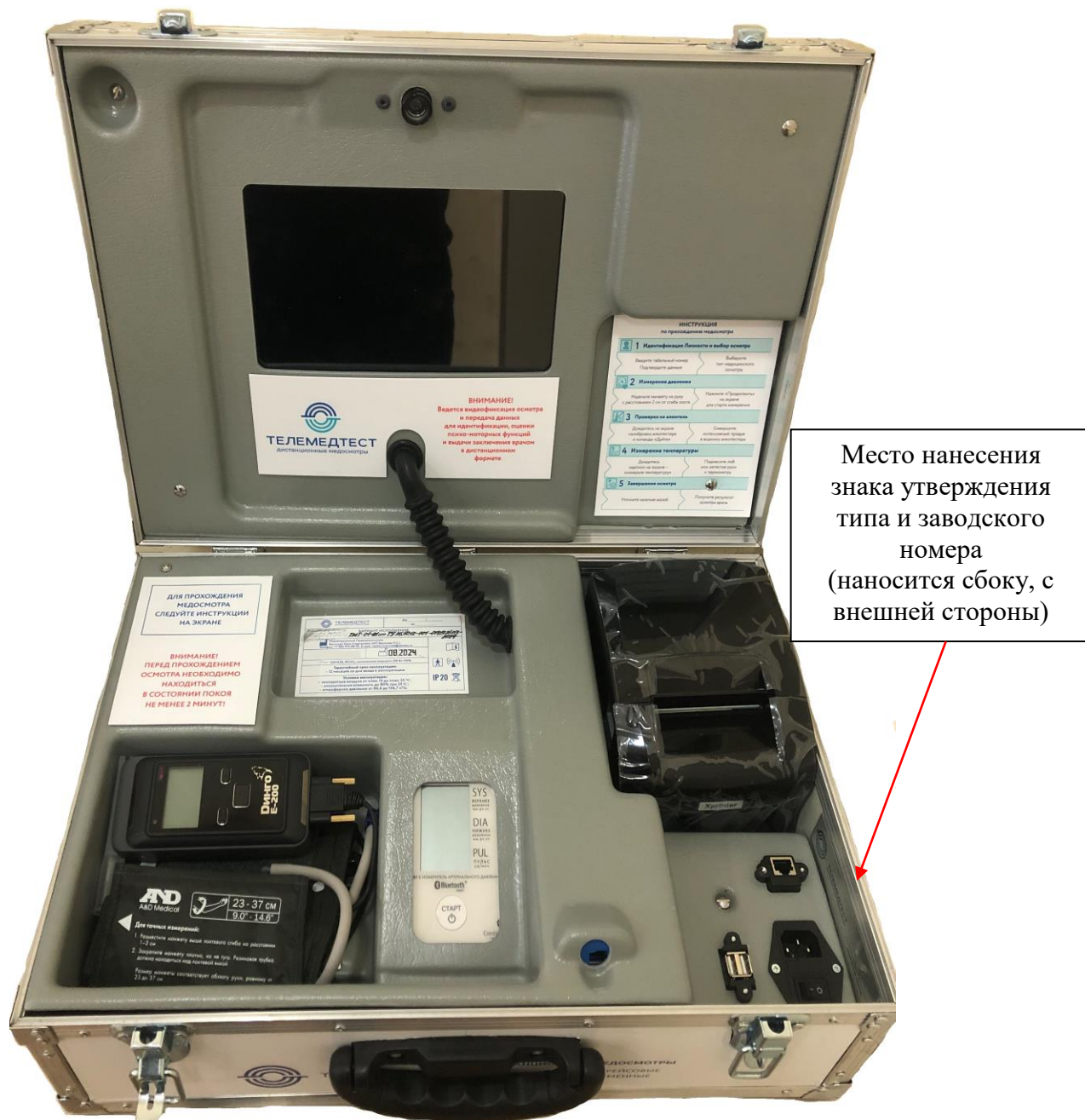
Рисунок 1 – Общий вид комплексов исполнения мобильный ТМТ-01-М с указанием места нанесения знака утверждения типа, места нанесения заводского номера
