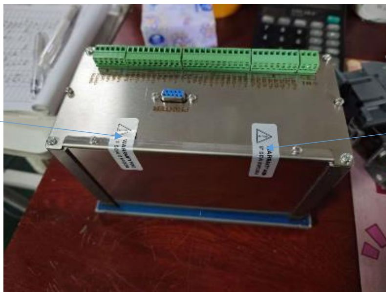
Рисунок 3 – Схема защиты приборов от несанкционированного доступа, место нанесения пломбы-наклейки
