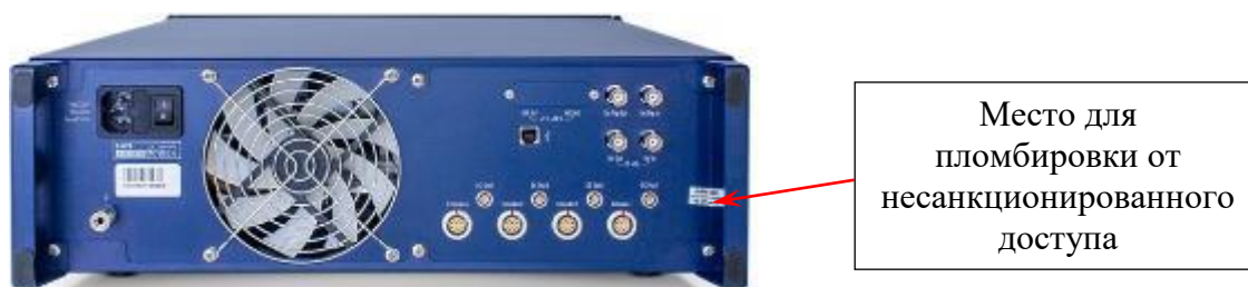
Рисунок 19 – Задняя панель ВАЦ с указанием мест пломбировки от несанкционированного доступа
