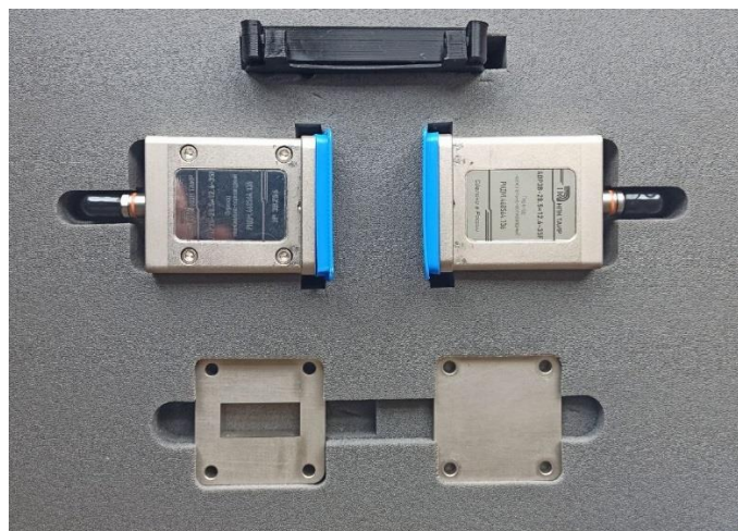
Рисунок 3 – Внешний вид наборов мер СК1W
