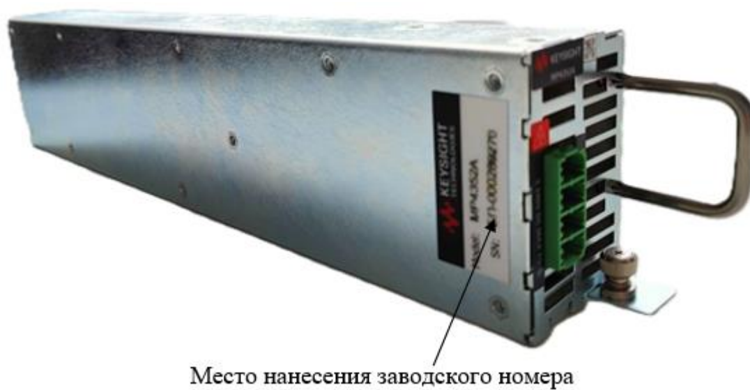
Рисунок 4 – Место нанесения заводского номера сменного модуля имитаторов солнечных батарей модульных Keysight MP4300A
