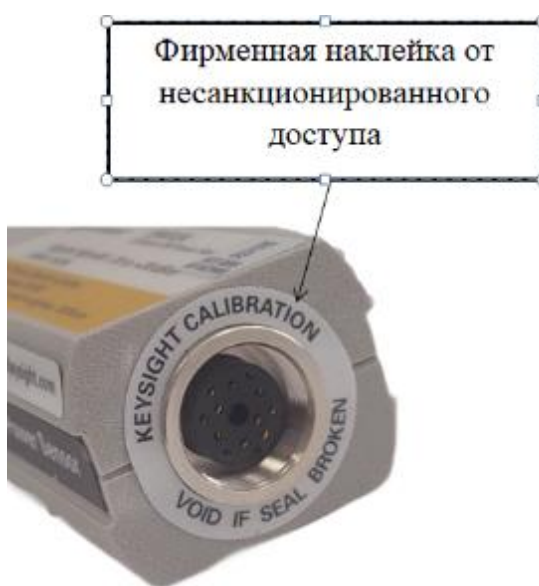
Рисунок 3 – Схема пломбировки от несанкционированного доступа
