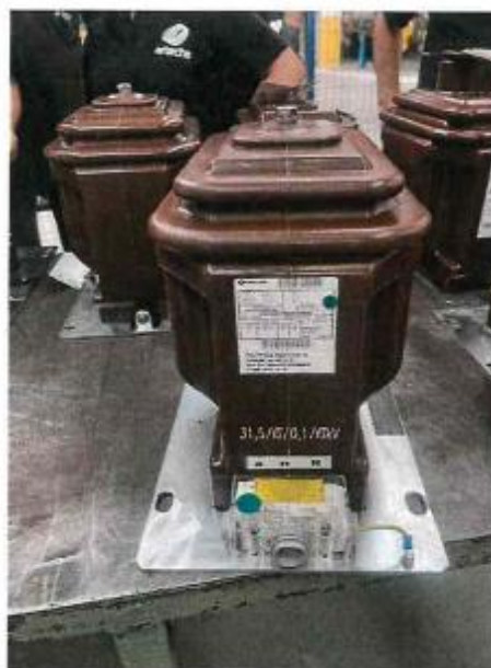
Рисунок 1 – Общий вид трансформаторов с модификациями и указанием места пломбирования от несанкционированного доступа, место нанесение заводского номера
