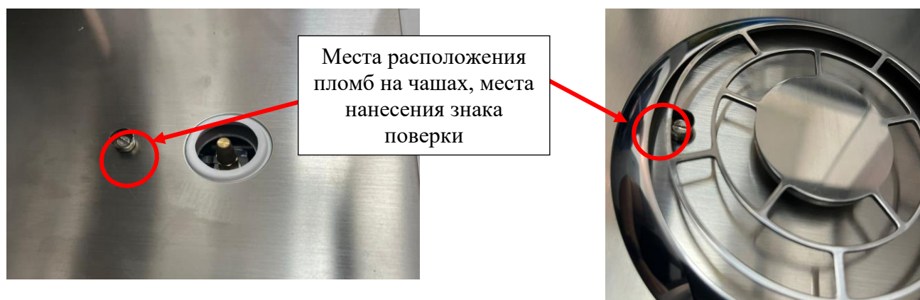
Рисунок 4 – Защита от несанкционированного доступа при внутренней юстировке
