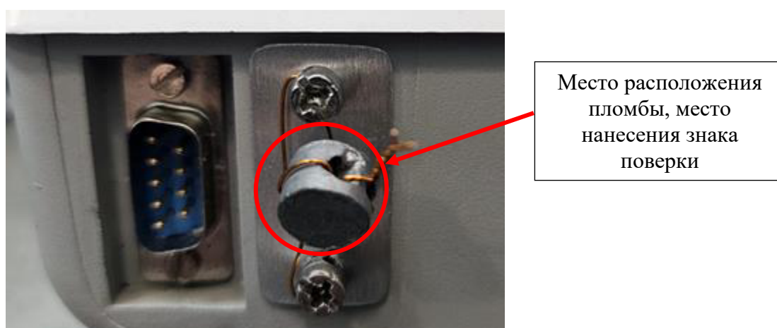
Рисунок 5 – Защита от несанкционированного доступа при внешней юстировке
