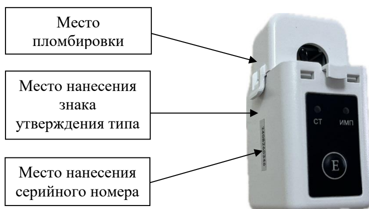
Рисунок 2 – Общий вид измерительного датчика с указанием места нанесения знака утверждения типа, места нанесения серийного номера и места пломбирования
