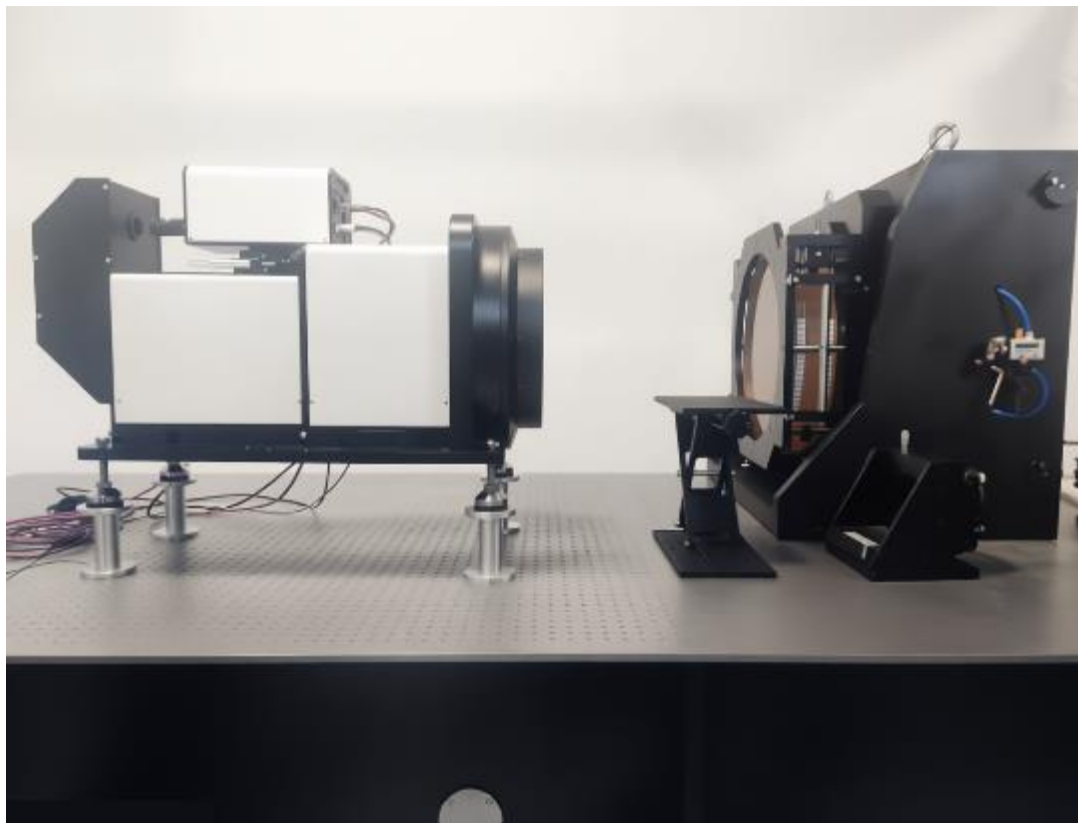
Рисунок 1 – Внешний вид интерферометров лазерных U-Optics IH-Dyna
