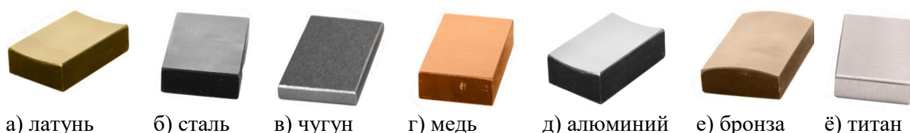
Рисунок 1 – Общий вид образцов шероховатости поверхности (сравнения)
