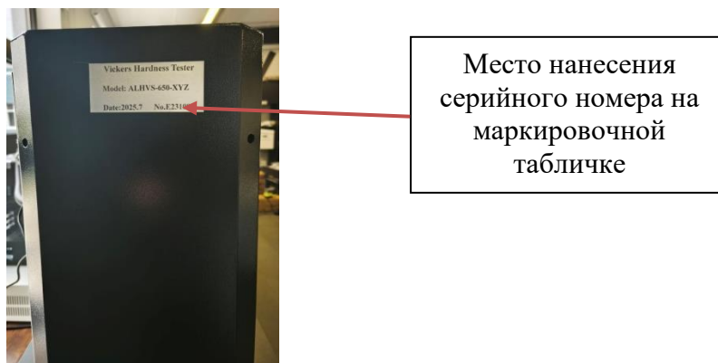
Рисунок 4 – Вид задней панели корпуса твердомеров с указанием места нанесения серийного номера
