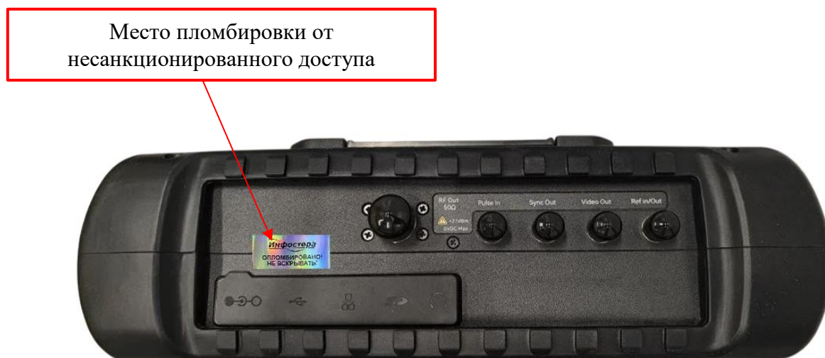
Рисунок 3 – Схема пломбировки от несанкционированного доступа
