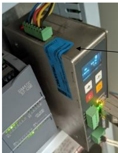
Рисунок 2 – Фото пломбирования терминала весов
