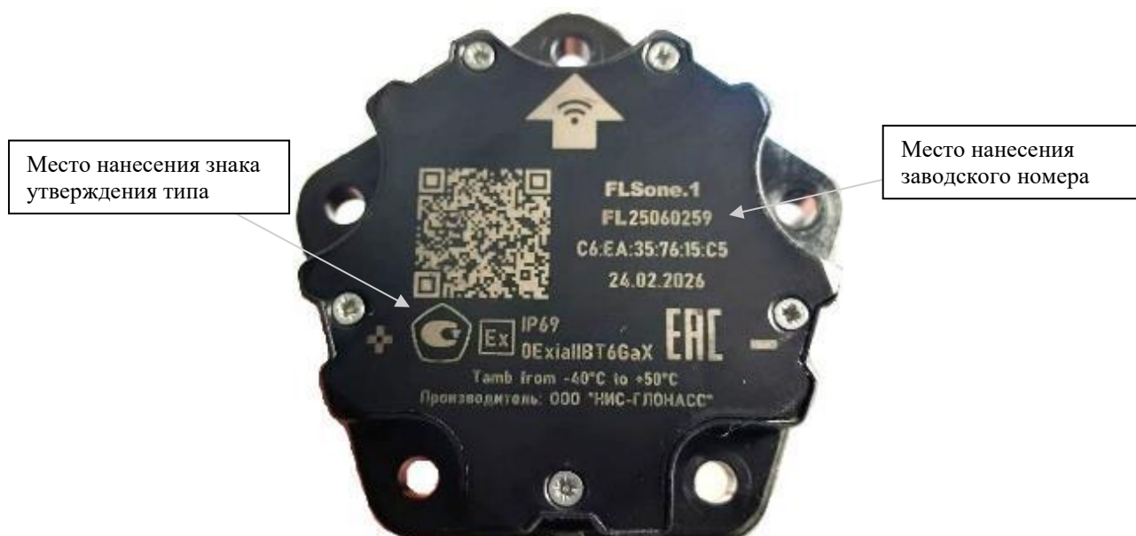
Рисунок 1 – Место нанесения заводского номера и знака утверждения типа
