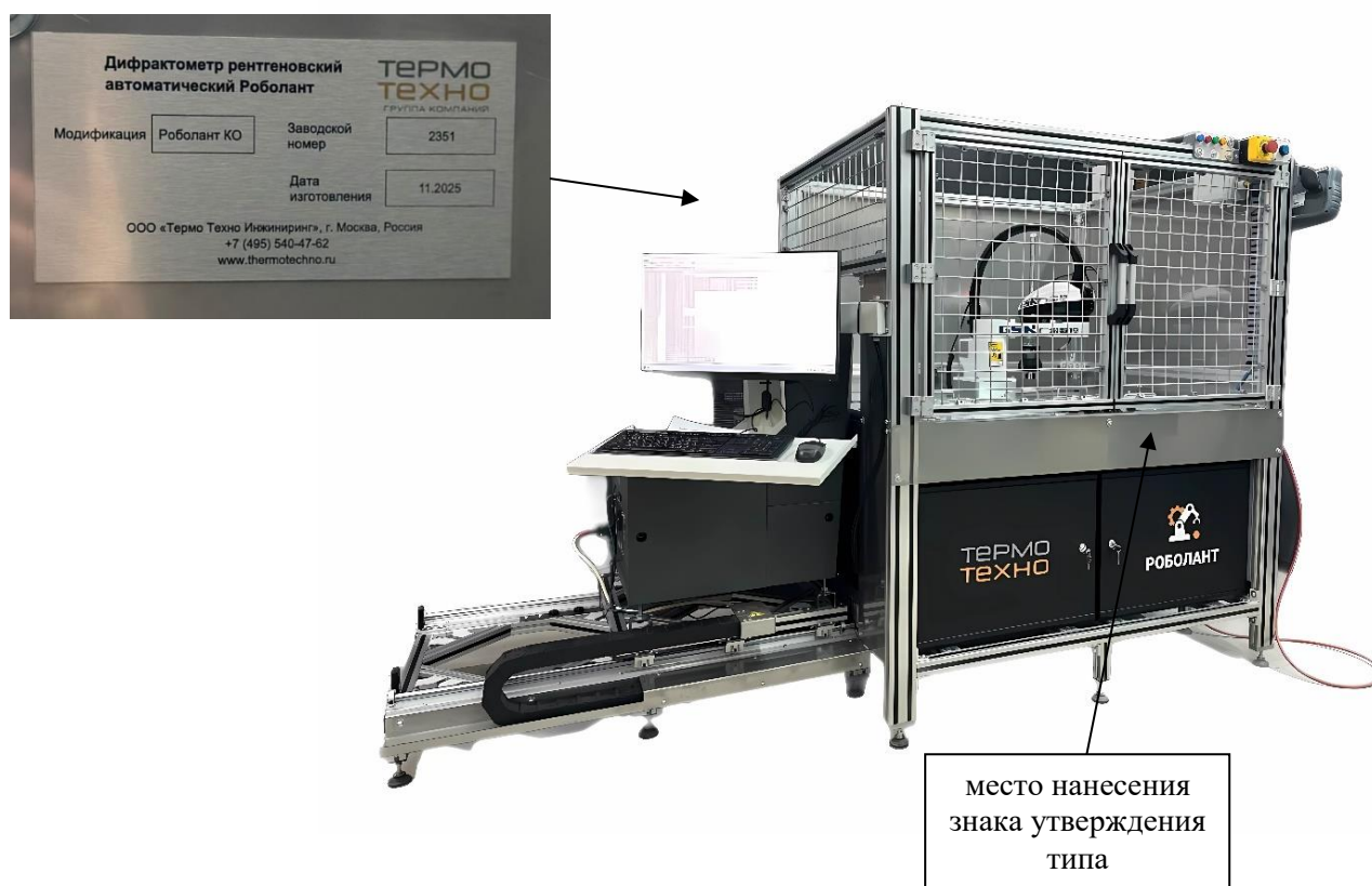
Рисунок 1 – Общий вид дифрактометров рентгеновских автоматических Роболант и маркировочной таблички с указанием места ее установки
